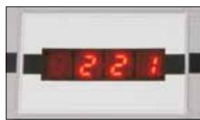
Beim Einsatz des Lok-individuellen Steuerungssystems »LISSY« oder der modularen Automatik für RailCom® »MARCo« werden die Zugnummern der Züge angezeigt, die den
