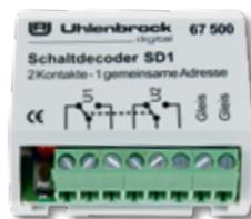
Universeller Schaltdecoder mit zwei getrennten, potentialfreien Umschaltkontakten, die unter einer Adresse gemeinsam angesprochen werden können. Ein Kontakt kann z. B. ein Lichtsignal bedienen und der zweite die Fahrspannung am Gleisabschnitt abschalten.
