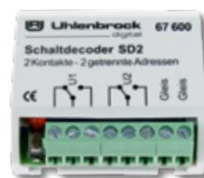
Universeller Schaltdecoder mit zwei potentialfreien Umschaltkontakten, die unter zwei Adressen unabhängig voneinander angesprochen werden können. Der Decoder schaltet unabhängig voneinander zwei verschiedene Verbraucher, beispielsweise Lichtsignale, Lampen oder motorische Weichenantriebe mit Endabschaltung.
