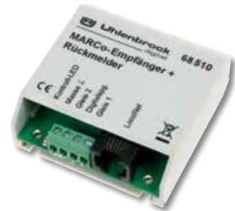
Sollen einfache Schaltfunktionen fahrtrichtungsunabhängig ausgeführt werden, so kann ein Modul zwei Gleisabschnitte überwachen. Dabei werden lediglich die Adresse der vorbeifahrenden Lok übermittelt und einfache Schaltaufgaben ausgeführt.
