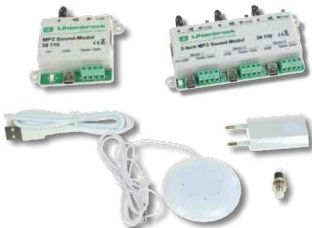
**Art.-Nr. 38 110** MP3 Sound-Modul mit USB-Kabel, Lautsprecher, Taster und Steckernetzteil
