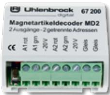
Schaltet per Impuls (+20V) über zwei Adressen unabhängig voneinander zwei Magnetartikel mit einem Antrieb (Weiche, Formsignal) oder einen Magnetartikel mit zwei Antrieben (Dreiwegweiche, Doppelkreuzungsweiche, Signal mit mit 2 ungekoppelten Flügeln). Der Baustein ist gegen Kurzschluss geschützt.
