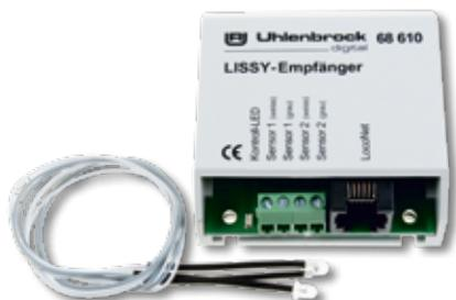
Der LISSY-Empfänger ist ein Modul mit zwei kleinen, kaum sichtbaren IR-Sensoren mit einem Durchmesser von 3 mm zum Einbau ins Gleis. Die Verbindung zur Digitalzentrale erfolgt über das LocoNet. Sollen die einfachen Schaltfunktionen fahrtrichtungsunabhängig ausgeführt werden, so kann ein Modul zwei Gleisstellen überwachen. Dabei werden lediglich die Adresse und die Zugkategorien der vorbeifahrenden Lok übermittelt und einfache Schaltaufgaben ausgeführt.
